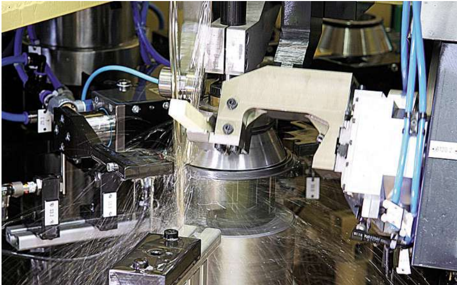
Bild 1: Aufgrund des flächigen Kontakts zwischen Werkzeug (Stein) und Werkstück werden Rundheitsfehler und Welligkeit reduziert. Es können Oberflächen bis zu 15 µm Tiefe abgetragen werden.
